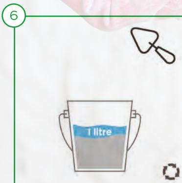
En son kalan 1 litre su, kıvama göre ayarlanarak katılmalıdır. Karıştırma işlemleri toplamda en az 4-5 dk. sürümlü olmalıdır. Mala ters çevrildiğinde dökülme yapmayan malzeme kıvama gelmiş demektir.
